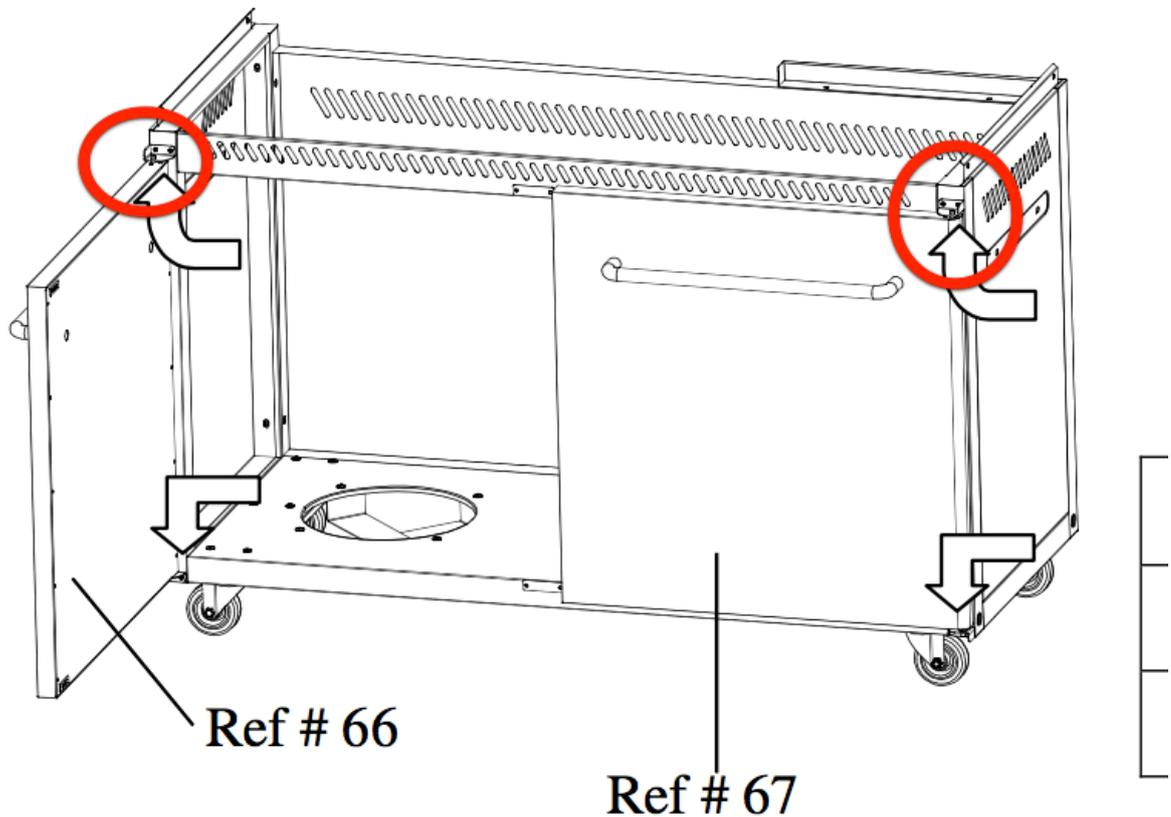
Bitte führen Sie diese Arbeiten auf einem gerade Untergrund durch, Ihr Grill sollte in Waage stehen, sollte der Grill schief stehen, z.B. Schotter, Pflastersteine, so ist eine Ausrichtung der Türen nicht möglich.
